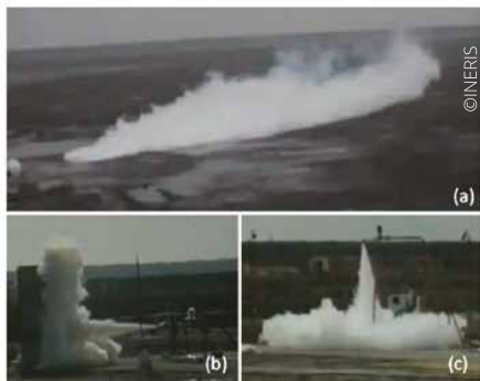
(a) Jet libre 10 mm, (b) Mur à 3 m et (c) Sol à 3 m
