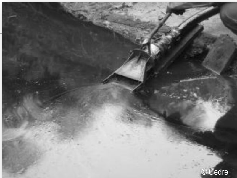
Utilisation de têtes plates de récupération
