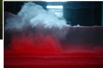
Illustration du déferlement et de l'extraction graphique d'une expérimentation d'atténuation de houle menée en canal.
