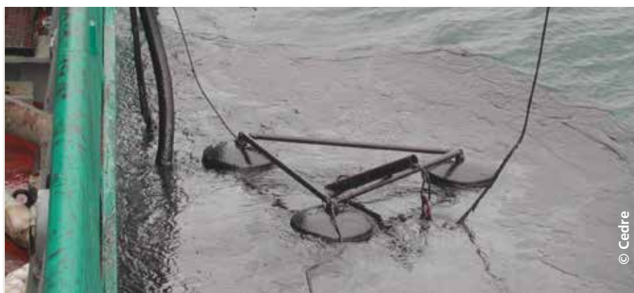
Collecte d'émulsion inverse à l'aide d'un récupérateur à seuil
