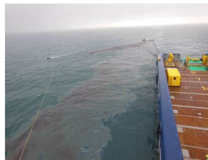
Mise en œuvre du MOSS Sweeper 50 à partir du Stril Luna (Source : NOFO)
