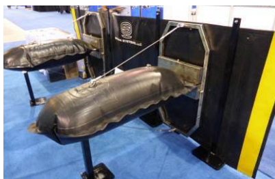
Gauche : Vue des flotteurs disposés en face externe des bras déviateurs de l'ORS-1000 (Source : Cedre) ; Droite : les 2 rangées de seuils/écremeurs concentrant l'huile à l'apex du dispositif (Source : Ocean Systems LLC)
