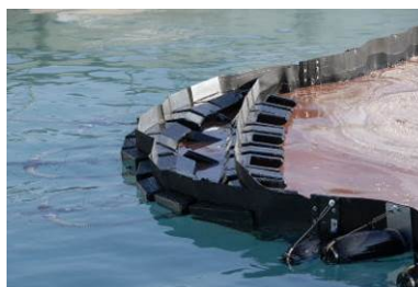
Gauche : Vue des flotteurs disposés en face externe des bras déviateurs de l'ORS-1000 (Source : Cedre) ; Droite : les 2 rangées de seuils/écremeurs concentrant l'huile à l'apex du dispositif (Source : Ocean Systems LLC)
