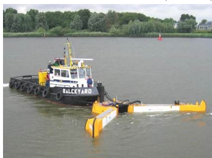
Le Victory Oil Sweeper opéré par un pousseur (Source : Koseq)
