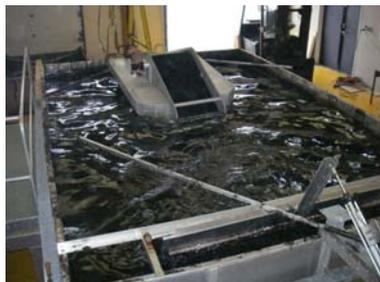
*L'Alligator 50 dans le bac d'essais en conditions de clapot*
