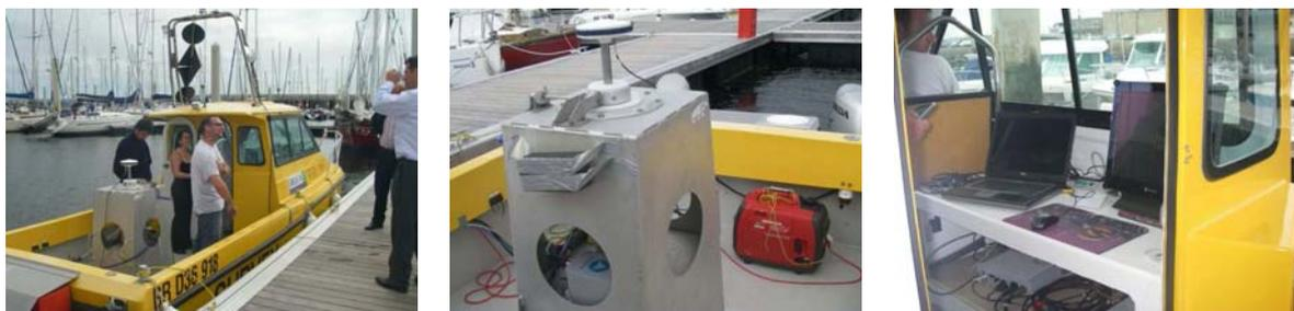
A gauche : Embarcation *Survey* de l'*Ensieta*. Au centre : Installation (sur puits existant) du sondeur, du logiciel navigation/stabilité, du récepteur GPS (*Proflex Magellan*), et du groupe énergie. A droite : PC/écrans de contrôle et module interface sonar (Source : *Cedre*)
