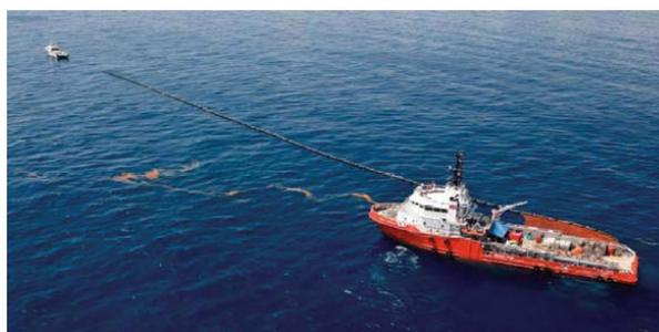
*Opérations de confinement et récupération mécanique (ici par le supply Pacific Protector) (Source : AMSA)*
