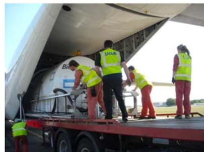
Chargement de l'*ADDS Pack* dans la soute du *L-382G*, à partir d'une semi-remorque (Source : Cedre)
