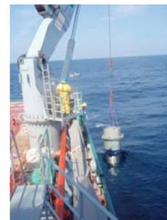
*Mise à l'eau d'un cylindre de déversement depuis le BSAD Ailette (Source : Cedre)*
