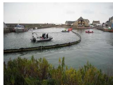
Configuration inadéquate en « S » du barrage Ro-Boom protégeant l'avant-port (Source : *Cedre*)
