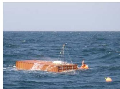
*Expérimentation LOST CONT : conteneur instrumenté équipé de ses chaînes de marquage (flotteur, système de largage hydrostatique, balise Argos,...) (Source : Cedre)*
