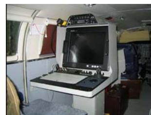
Poste de l'opérateur du système de détection
