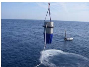
Montée du cylindre de déversement et formation d'une nappe en surface.
