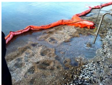
Secteur ouest de la plage du Jai : test préliminaire de brassage (jet d'eau basse pression) des sédiments pollués : récupération, par boudin absorbant, de la pollution piégée dans les sédiments et remobilisée par jets d'eau (Source : Cedre)
