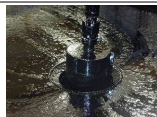
Récupérateur DESMI Terrapin en suspension, avec manche d'aspiration en connexion haute (Source : Cedre)
