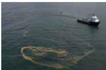
Confinement des « nappes » (balle de riz) par barrage flottant déployé depuis le BSAD Argonaute.
