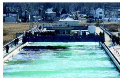
Tests de dispersion de brut dans les bassins expérimentaux de l'OHMSETT
