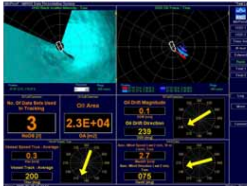
Interface du système OSD : détection d'une nappe d'hydrocarbures (gche) et visualisation de son extension et de sa dérive après traitement de l'image (dte) (Source : Miros )
