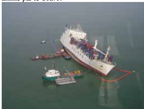
Vue d'ensemble du dispositif de pompage des soutes et compartiments du Rokia Delmas (Source : Cedre)
