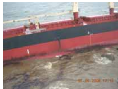
01/06/06 : Fuites à partir du navire fissuré (Source : ICG)
