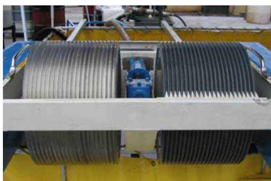
Vue du récupérateur à tambours oléophiles : la surface est creusée de sillons (angle de 30°, profondeur de 25.4 mm). Noter le système de « dents » pour la récupération des hydrocarbures logés dans les sillons. (Source : UCSB)
