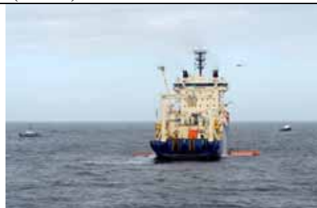
Le câblier Ile de Bréhat, sweeping arms déployés, durant un exercice antipollution au large du Portugal (15 septembre 2006) (Source : EMSA).
