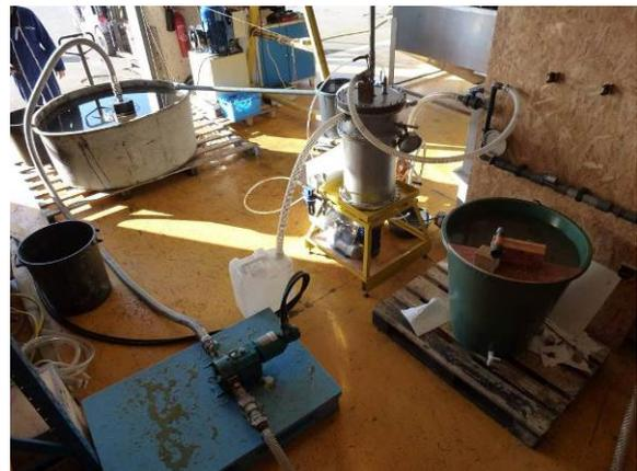
Tests du Turbylec, au Cedre, associé à un récupérateur *DESMI Terrapin* et à une pompe *Börger AL25* (Source : Cedre)
