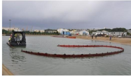
Bassin et plage artificielle du Cedre : remorquage d'un barrage en configuration de chalutage (source : Cedre)
