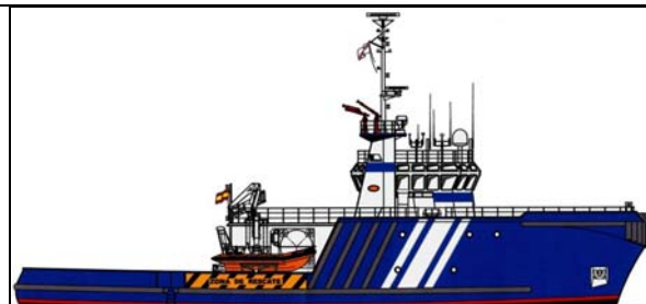
le Sebastian de Ocampo (774 GT, 41 m de long, 13 m de large, 5.14 m de tirant d'eau, 14 nds, 55 tonnes de traction au crochet) (source Xunta de Galicia)
