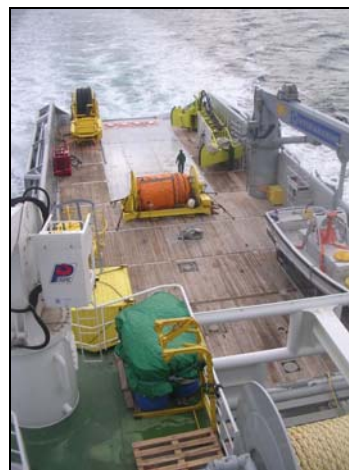
Les équipements de confinement-récupération installés sur la plage arrière de l'Argonaute (source Cedre)
