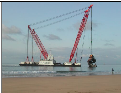
la barge Rambiz et grappin (source : Cedre)
