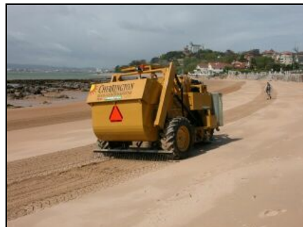
Cherrington Beach Cleaner : bac récepteur (source : Cedre)
