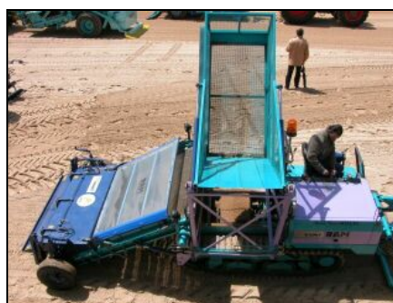
Ram Beach Track Multi : bac récepteur perforé (source : Cedre)
