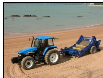
Cribleuse Moreau Tamistar : attelage (source : Cedre)
