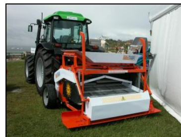
Cribleuse PFG Balena (source : Cedre)
