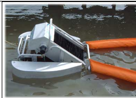
Récupérateur DESMI Alligator (source : DESMI)
