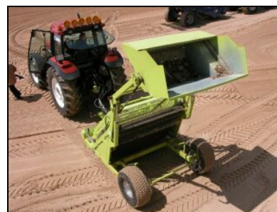
Bac récepteur de la ratisseuse (source : Cedre)
