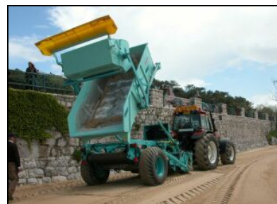
Beach Tech STR 3000 : bac récepteur et benne intégrée (source : Cedre)
