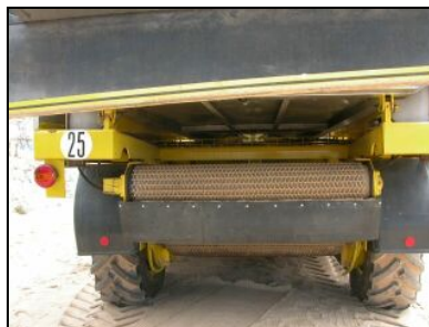
Tapis cribleur de l'automotrice (source : Cedre)
