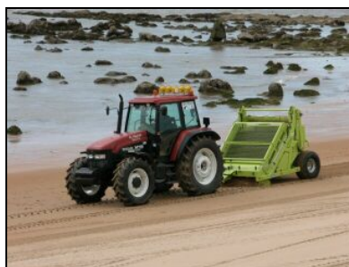
Ratisseuse Barber Surf Rake 600 HD (source : Cedre)
