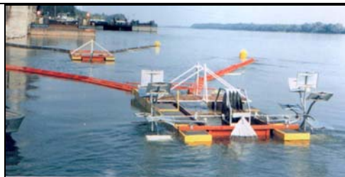
Système de récupération Harmadik Dimenzio (source : Harmadik Dimenzio 2002 KFT)
