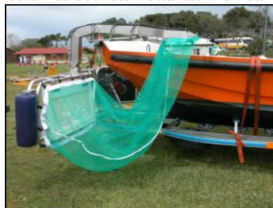
Poche de filet montée sur cadre (source : Cedre)
