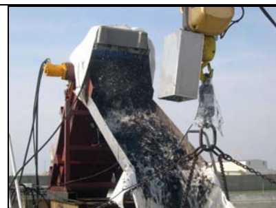
Bande Egmolap avec son dispositif d'injection d'eau sous pression (source Cedre)
