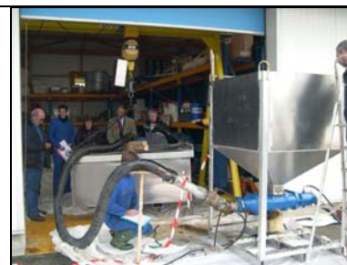
Pompe Egmo W200 avec son dispositif d'injection annulaire d'eau (source Cedre)
