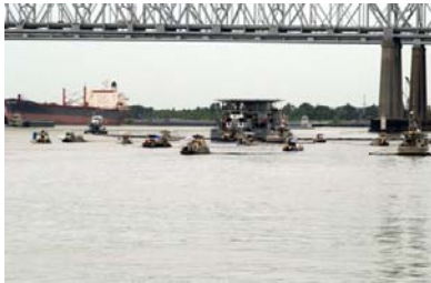
Dispositif de prévention autour de l'épave : barge HOSS et barges récupératrices MARCO (Source : USCG)
