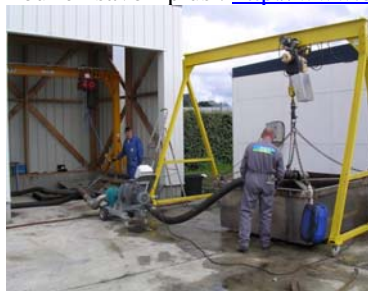
Tests en bac sur portique
