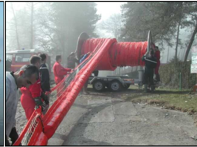
Repli du barrage flottant (source : Cedre)
