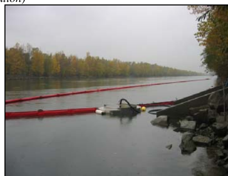
L' Hydrodynamic Circus , le Foilex et la Depa : c) en préparation ; d) En fond de poche de confinement (source Le Floch Dépollution )
