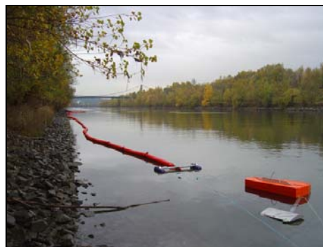
Le paravane Boom Vane et le stabilisateur du barrage : a) en préparation; b) en début d'écartement sur l'eau (source Le Floch Dépollution )
