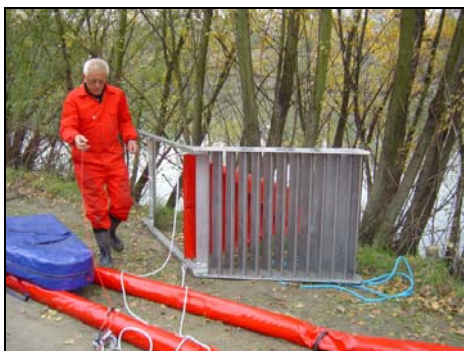
Le paravane Boom Vane et le stabilisateur du barrage : a) en préparation; b) en début d'écartement sur l'eau (source Le Floch Dépollution )
