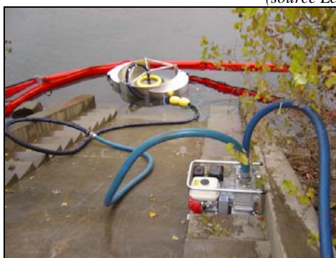
L' Hydrodynamic Circus , le Foilex et la Depa : c) en préparation ; d) En fond de poche de confinement (source Le Floch Dépollution )
