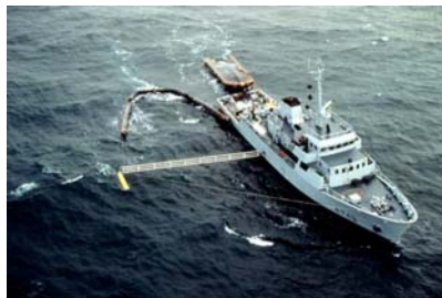
Le barrage-récupérateur Sillinger Sirène 20 à couple d'un navire (ici de la Marine Nationale) tractant un bac de stockage flottant : ici un Sillinger Pollutank. (Image d'archive Cedre)
