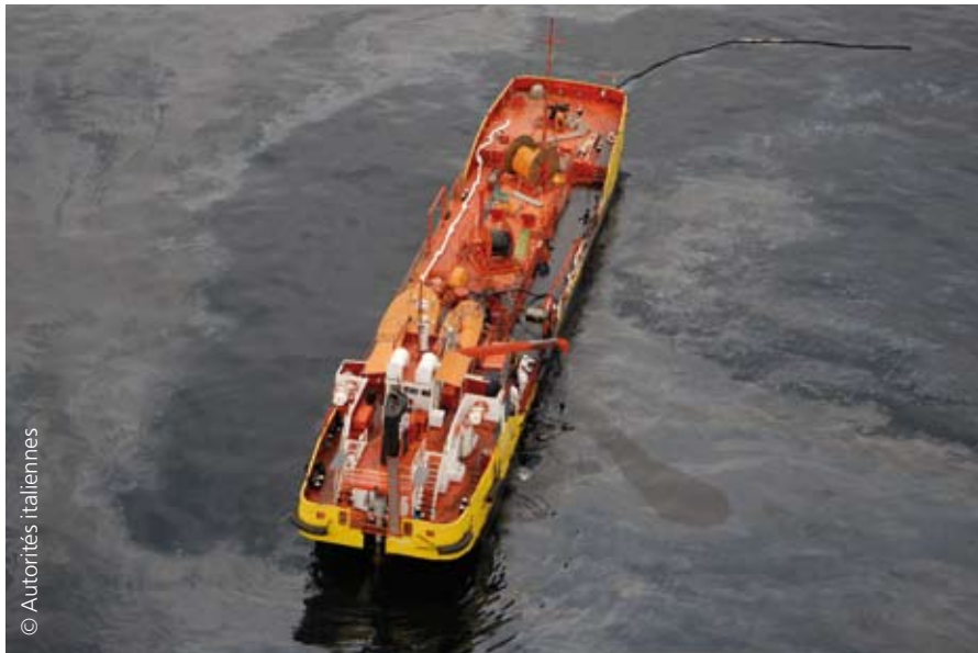
Barrage absorbant à l'avant du navire Navire antipollution italien « San Giacomo »
