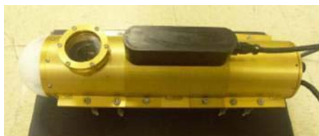
Vue du prototype du capteur Oscar , d'hydrocarbures submergés ou coulés (Source :
