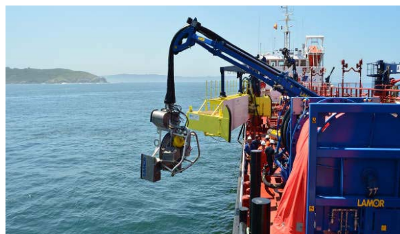
Tests en mer du système Lamor LWS 1 300 équipant dorénavant le pétrolier Monte Arucas (Source : AESM)
