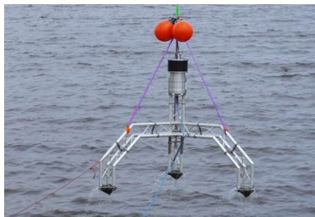
Mise à l'eau d'un ALDS (Source : Sonardyne)
