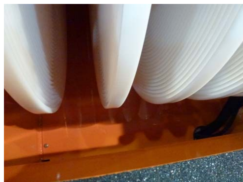
Vue de détail de la surface cannelée des disques oléophiles du récupérateur Elastec X150 (Source : Cedre )
