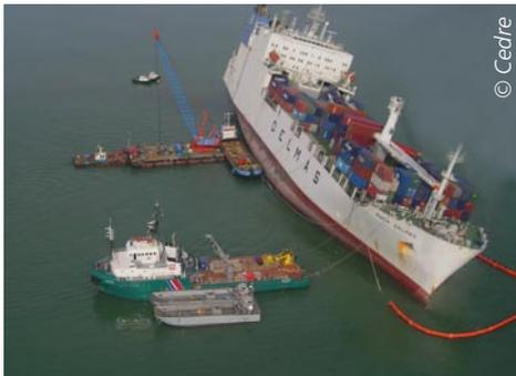
Après avoir mouillé une ancre, vers 5h00, le bâtiment talonne dans le Sud de La Couarde-sur-Mer et se pose sur un fond sablo-rocheux. Il gîte sur bâbord (18 degrés), sa cargaison (bois débité et cacao notamment) est partiellement désarrimée. Le navire a en soutes près de 500 tonnes de fuel (IFO 380) et 50 t de Diesel marine. Aucune pollution n'est observée, mais une voie d'eau est rapidement
