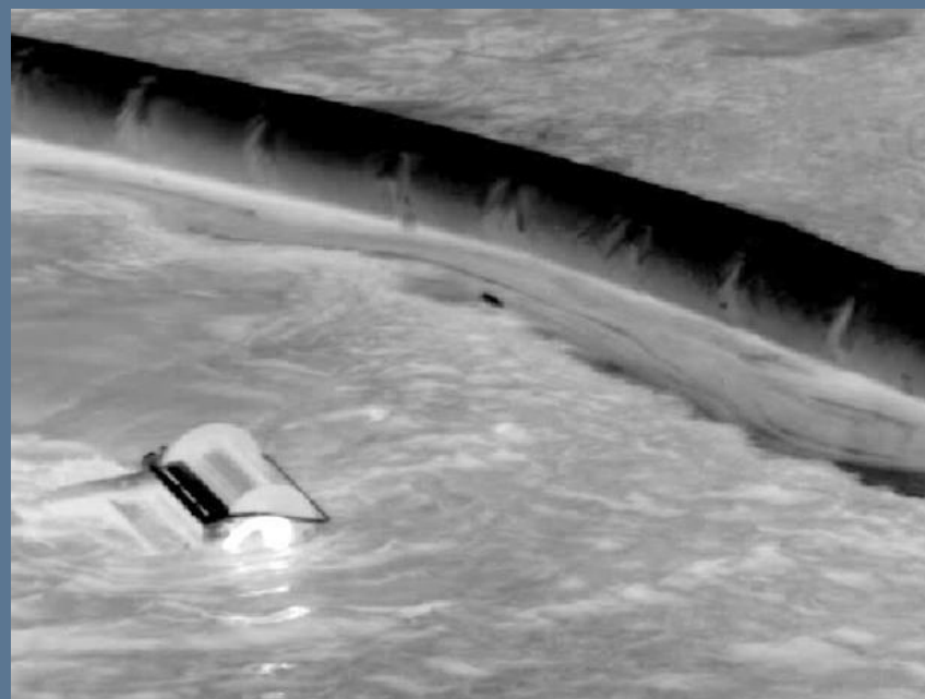
Caméra IR : identification nocturne de fuites sous un barrage (à gauche) et guidage d'un skimmer (à droite), source Aptomar
