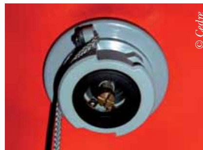
Détail d'une valve avec son système de ressort/clapet
