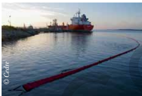
Confinement autour d'un pétrolier à l'appontement
