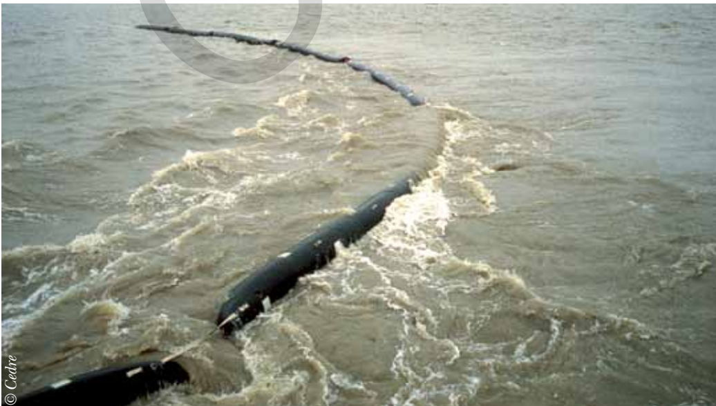
Limite d'utilisation d'un barrage dans le courant
