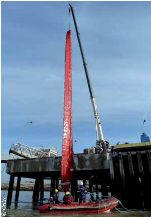
Sortie d'un barrage barrière suite à un déploiement à partir d'un appontement
