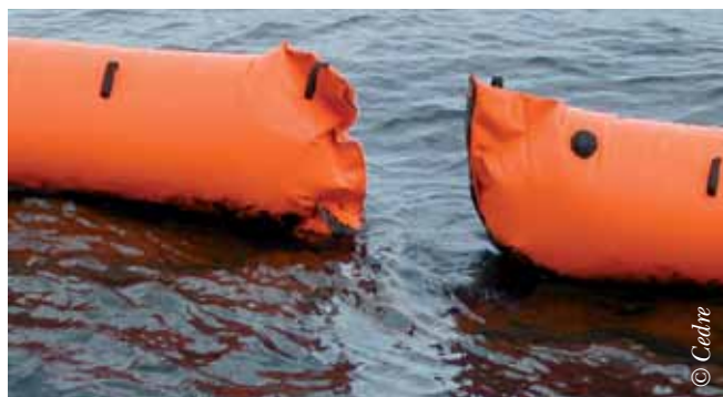
Rupture d'un élément de liaison lors d'opérations de récupération en mer (pollution du Prestige, Espagne)
