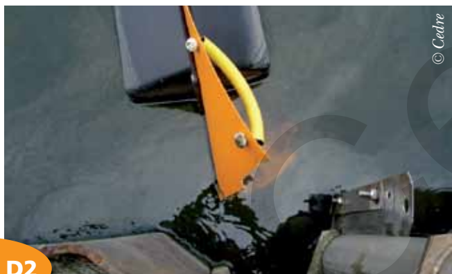
Arrachage au niveau du compensateur de marée
