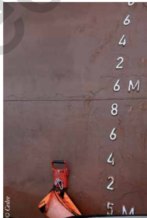
Ancrage magnétique sur coque de navire
