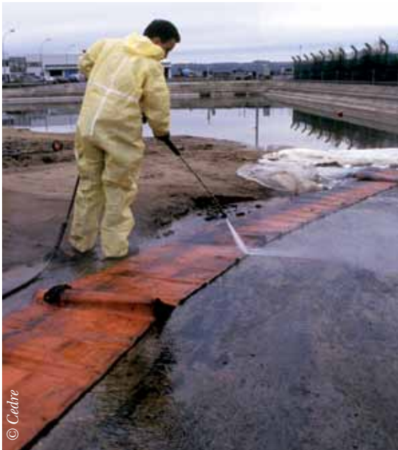
Nettoyage haute pression des barrages antipollution
