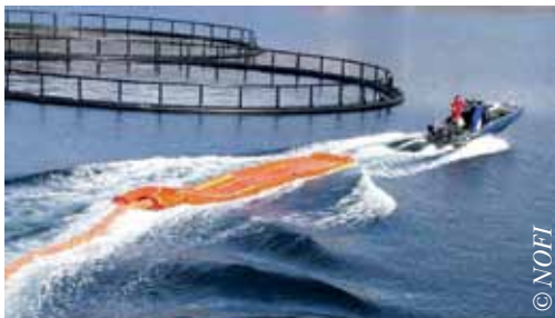
Barrage stocké dans un dispositif remorquable
