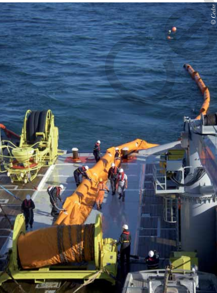
Déploiement d'un barrage rideau gonflable
