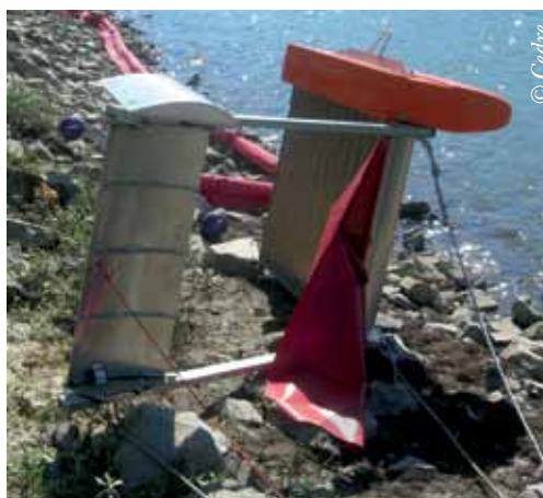
Détail du paravane disposé sur une berge avant sa mise à l'eau
