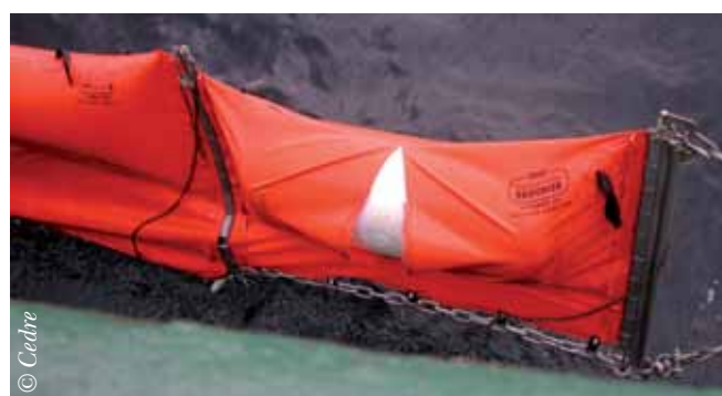
Déchirure lors du remorquage d'un barrage gonflable, suite à un effort de traction trop important
