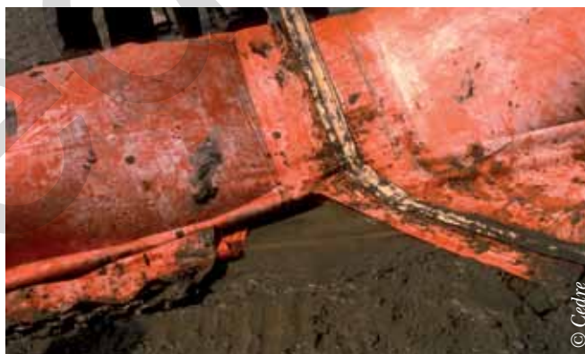
Rupture de la chaîne entraînant une déchirure
