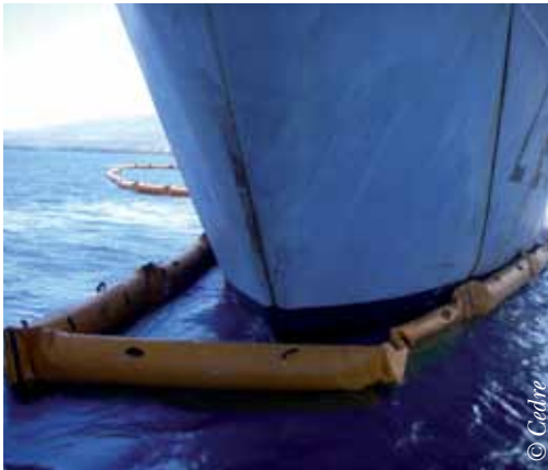
Barrage positionné au niveau de l'étrave d'un navire
