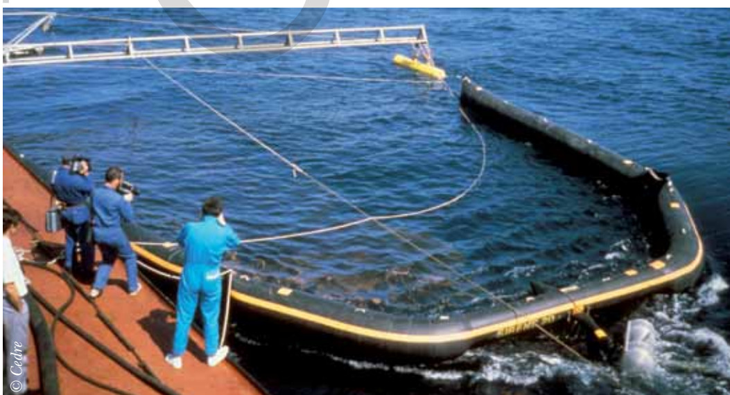
Barrage sur tangon intégrant un dispositif de récupération, déployé à partir d'un seul navire
