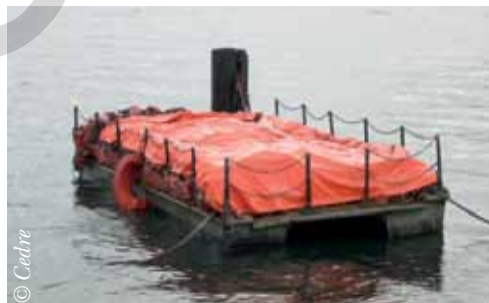
Barrage sur ponton flottant
