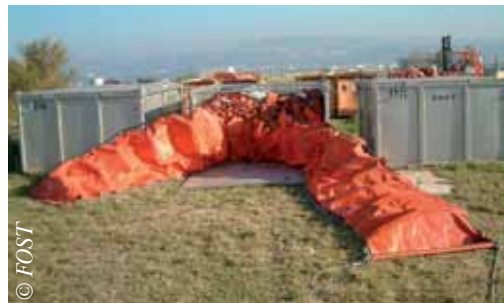
Barrage rideau à pain de mousse non compartimenté en conteneur
