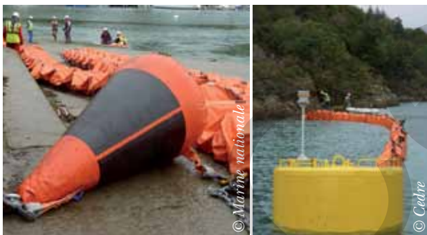
Coffre gonflable conique (à gauche) et coffre métallique (à droite)
