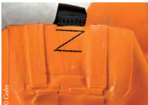
Assemblage de différentes pièces de tissus par thermosoudage
