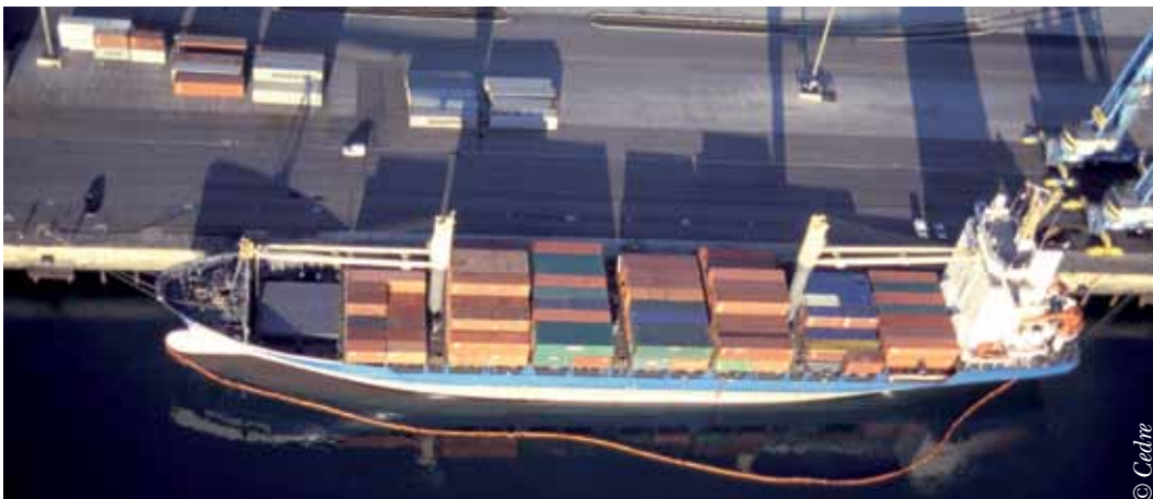
Barrage antipollution mis en place pour prévenir d'éventuelles fuites, Melbridge Bilbao, 2001
