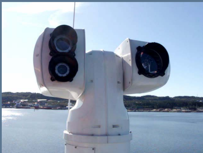
Système Securus qui combine caméra IR et caméra visible BNL, source Aptomar
