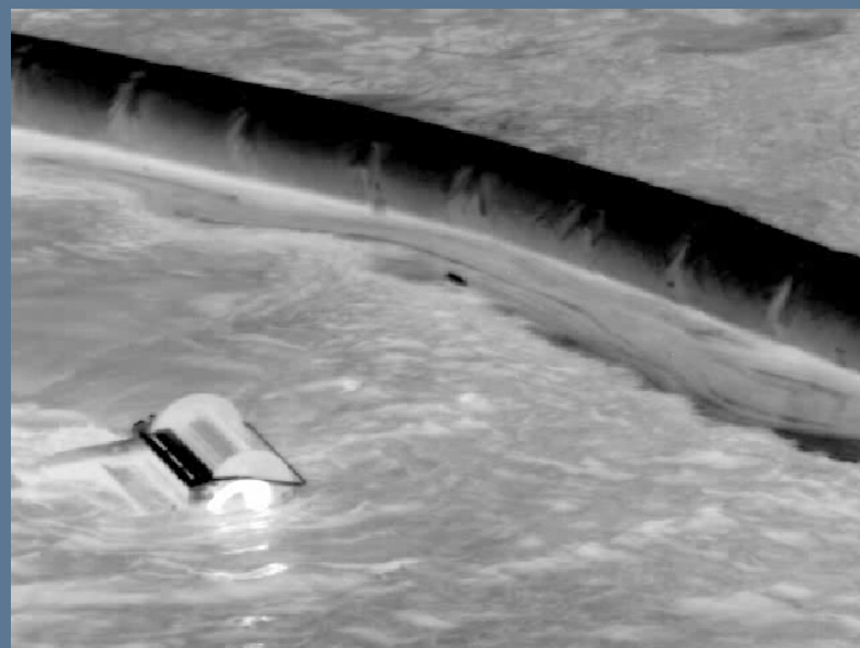
Aide au positionnement d'un skimmer dans une nappe confinée, source Aptomar
