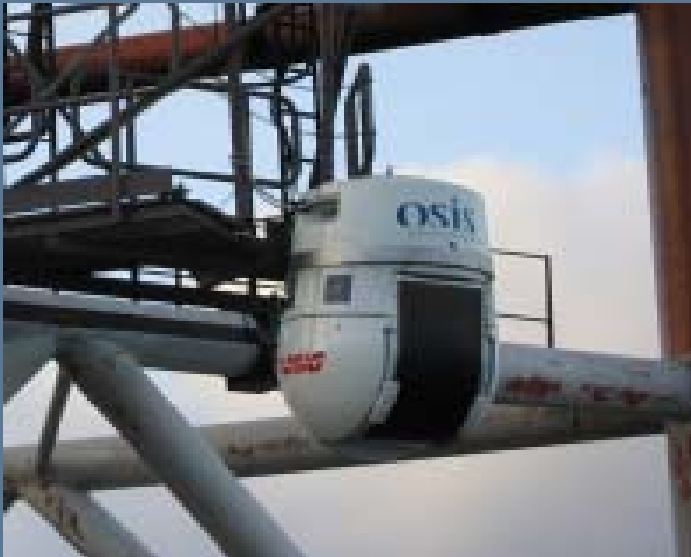
Radome abritant l'antenne radar et le radiomètre , source OSIS
