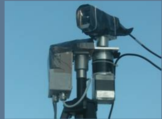
DEPOL 07 : la caméra infrarouge thermique du projet DETHERPOLMAR – Source Cedre
