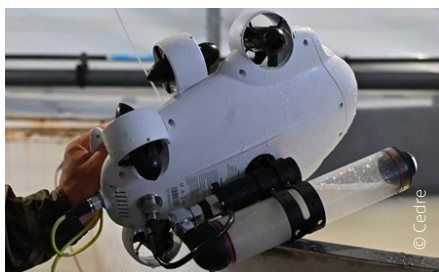
▲ Drone sous marin FIFISH V-EVO avec sa seringue de prélèvement (500 mL)
