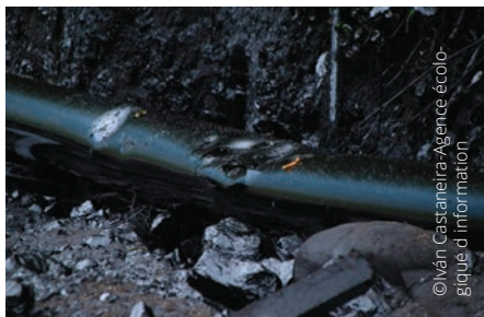
^ Vue de la brèche sur le pipeline (gauche) ; Sols et végétation du ravin ayant été aspergés par le geyser de pétrole sous pression du pipeline (droite)
