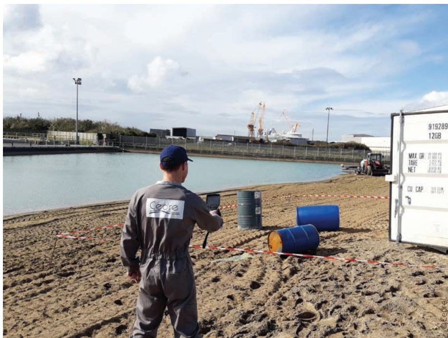
^ Mesure d'échauffement de produits chimiques par caméra thermique
