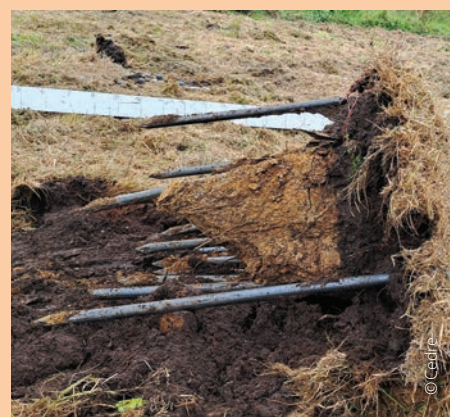
△ Plaque d'ancrage après essai
