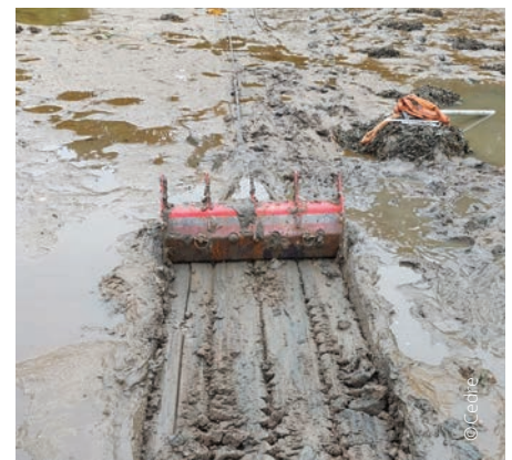
▲ Ancre à griffes après essai dans la vase
