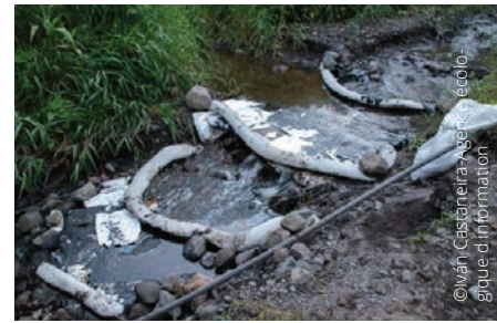
^ Vue de la brèche sur le pipeline (gauche) ; Sols et végétation du ravin ayant été aspergés par le geyser de pétrole sous pression du pipeline (droite)
