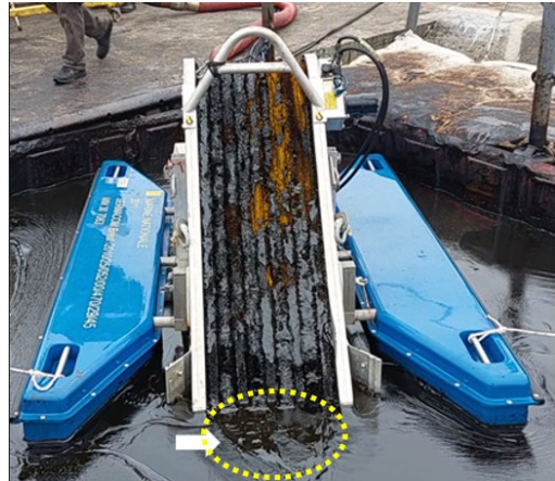
Fragmentation de la nappe de VLSFO 2, visqueux à quasi-solide, avec formation d'une surface d'eau libre en front de brosse linéaire (source : Cedre)
