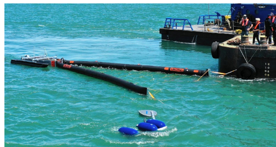
Vikoma Paravane Midi-Maxi (ici associé à un barrage récupérateur Fasflo Maxi ) amarré à un point de tire sur barge (source : Vikoma)
