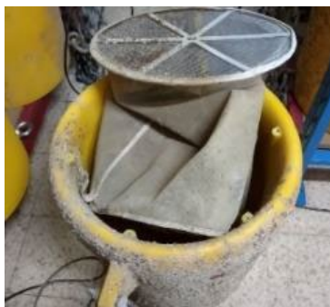
Relevage du piège flottant pour vidange du filet de collecte (source : Seabots)
