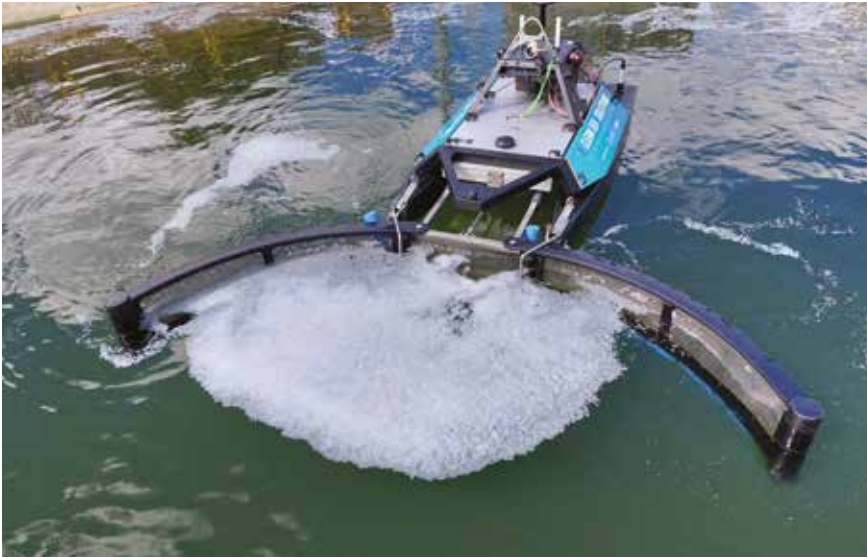
Évaluation de drones de surface dans les bassins du Cedre avec essai de récupération de Granulés Plastiques Industriels (GPI)
