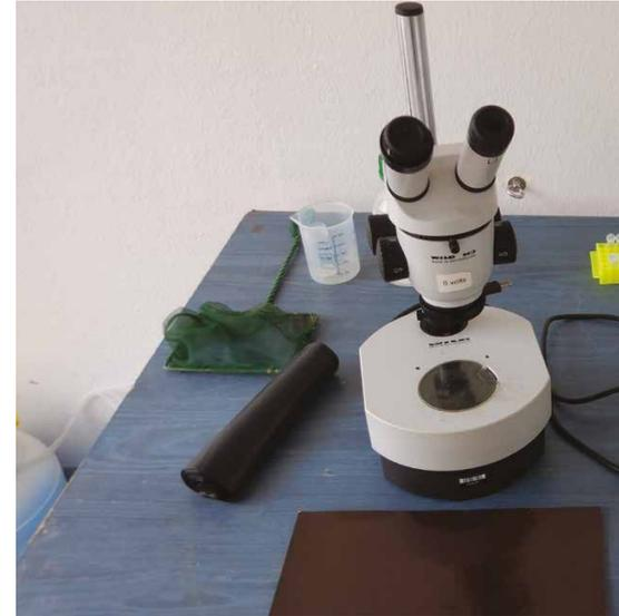
▲ Matériel de dissection pour prélever les échantillons dissection, Eppendorf, azote liquide)
