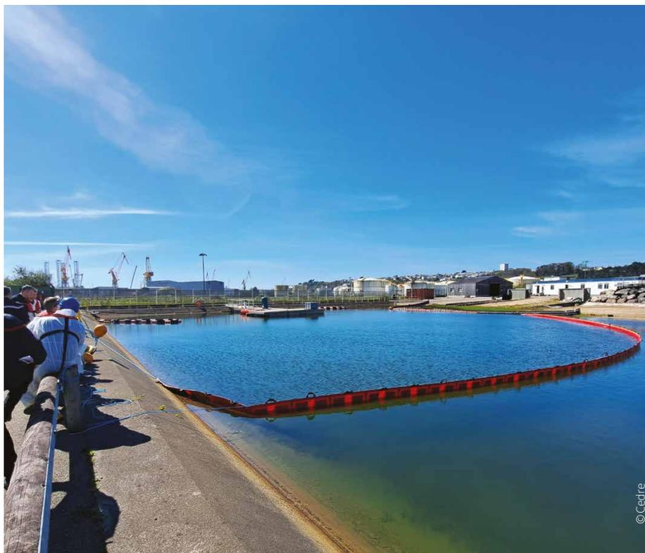
^ Formation pose de barrage flottant pour le SDIS 29 au Cedre
