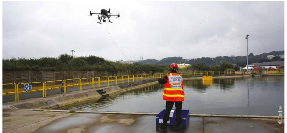
^ Test de drones et capteurs sur les bassins du Cedre dans le cadre du projet IRA-MAR
