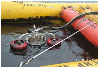
Système d'allègement NorMar IPS 3, avec pompe immergée DOP 160. Noter la gaine correspondant à l'ombilic et à la manche de refoulement (photo de droite) (source : NOFI)
