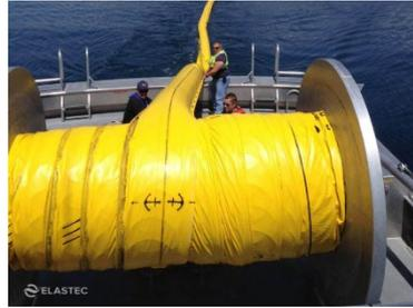
Déploiement du barrage autogonflant léger Sea Curtain Barrel-O-Boom à partir d'un pont (gauche) ; Déploiement en d'un modèle lourd Sea Curtain Hi-Seas à partir d'un remorqueur (droite) (source : Kepner Plastics Fabricators Inc.)
