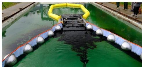
Vue du prototype *Restricted Burning Tongue*. Noter, entre les bras concentrateurs (*PyroBoom Desmi*) et la zone de brûlage (matérialisée par le barrage *FireBoom*, en jaune), le dispositif d'épaississement de nappes muni d'une « porte » (Source : *BSEE*)
