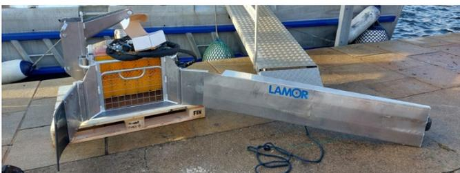
En bref, il s'agit d'un bras de confinement rigide (aluminium) permettant une largeur de balayage de 2,5 mètres, associé à un récupérateur oléophile à brosses rotatives en polyéthylène à débit nominal faible (affiché
