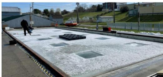
Bassin du CRREL : surface englacée avec ouvertures (1m<sup>2</sup>) pratiquées pour les déversements expérimentaux (source : USCG RDC)
