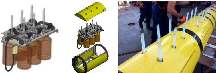
Schéma de l'échantillonneur sous-marin Midwater Oil Sampler et de son mode d'installation sur l'AUV REMUS 600 (source : Woods Hole Oceanographic Institute)
