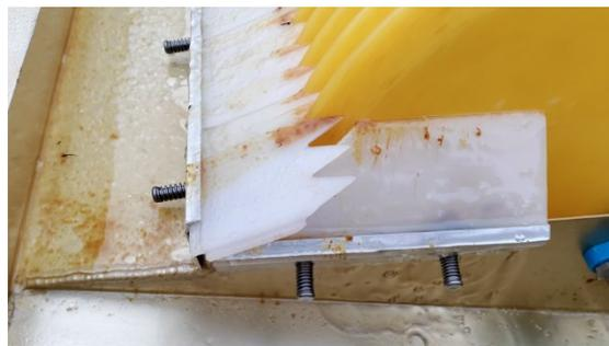
*Gauche : Aspect visuel de la séparation en phases d'un B7 vieilli à l'air libre durant 68 jours ; Droite : Vue détaillée du racloir du TDS118G ; faible débit de collecte de la phase liquide/huileuse de B7 vieilli et récupération partielle d'agrégats gélatineux (couleur orangée) (Source : Cedre)*
