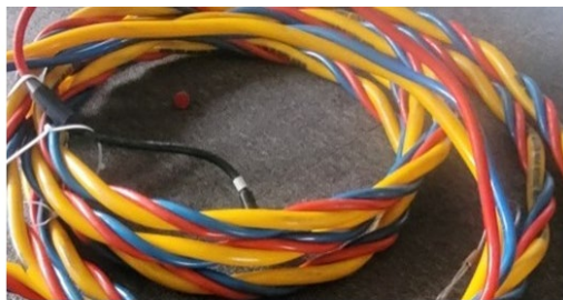
Narguilé (câble bleu = air ; câble rouge = communication ; câble jaune = hauteur d'eau)
