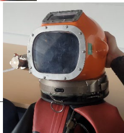
Narguilé (câble bleu = air ; câble rouge = communication ; câble jaune = hauteur d'eau)
