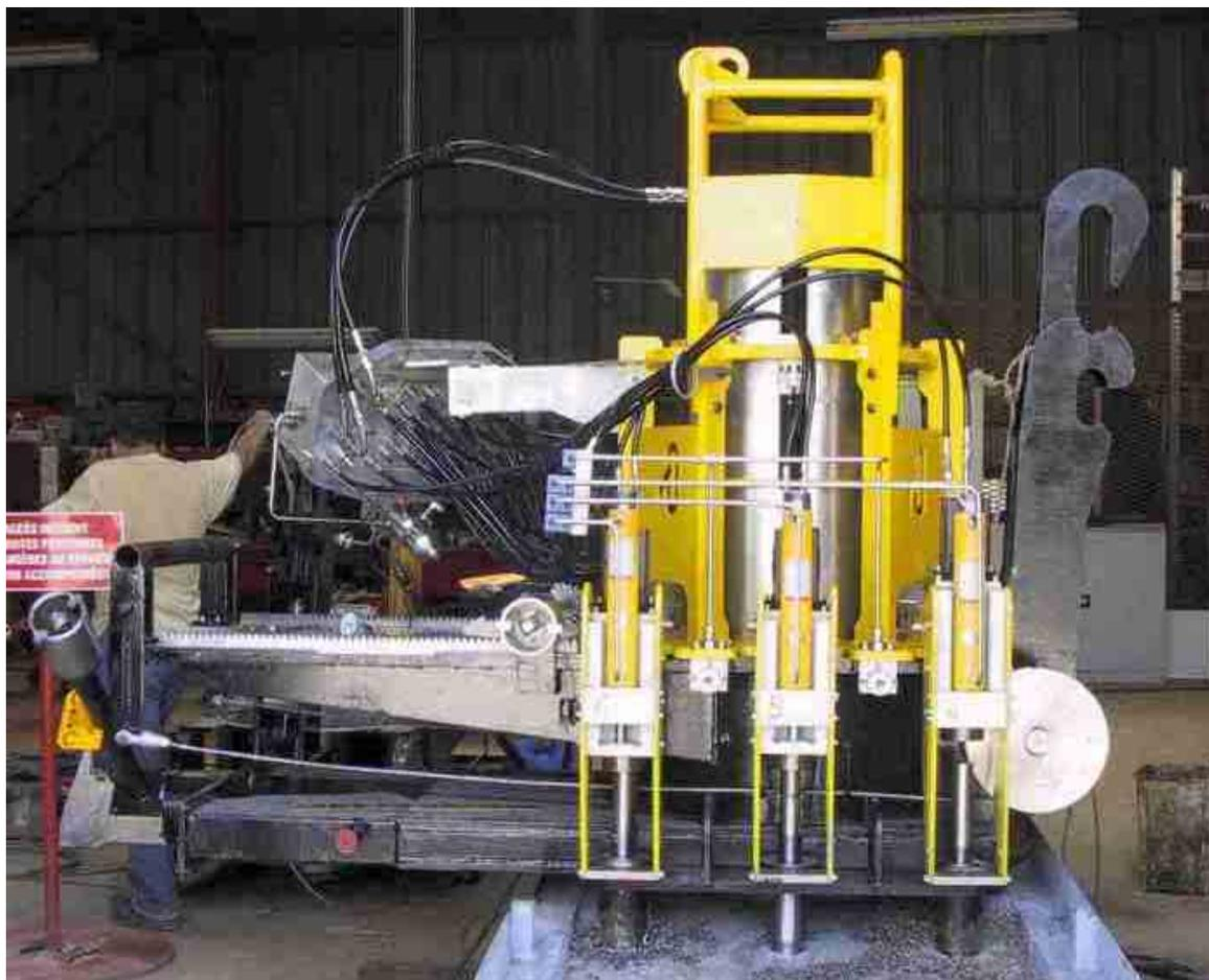
Ce système est conçu pour perforer le pont du prestige en utilisant une machine spécialement élaborée pour installer et tester une soupape à double extraction avant de perforer l'épave
