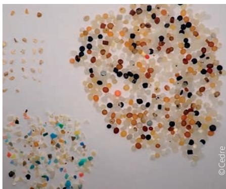
^ Illustration d'un tri de grands microplastiques issus d'un prélèvement du réseau de surveillance
