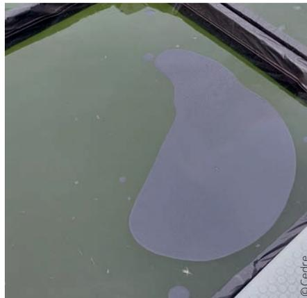
^ Nappe d'un mélange hydrocarbures-GPI préparé artificiellement
