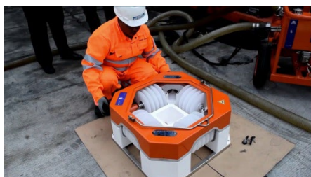
Ecremeur oléophile DESMI DBD 13-4 ici équipé de 4 bancs rotatifs à disques (Source : DESMI)
