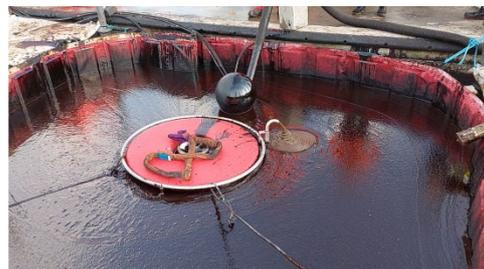
Mise à l'eau du *FORU-70* dans la zone de test (bassin expérimental du Cedre) ; série de tests sur fioul lourd (source : Cedre)
