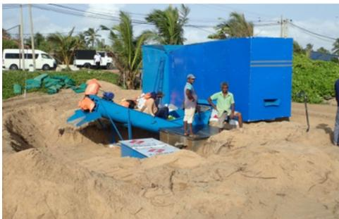
Installation d'un prototype de machine de nettoyage des sables, en vue de tests ultérieurs (Sarakkuwa, 24/06/2021) (source : Cedre)
