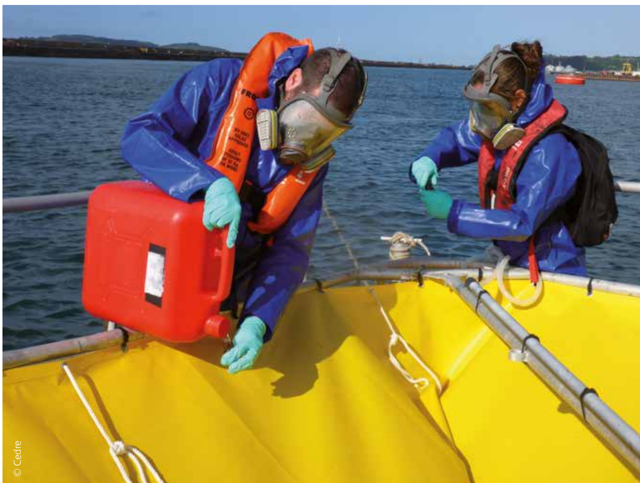
Déversement d'un produit chimique dans une cellule de confinement en mer
