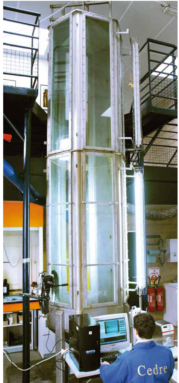
Colonne d'expérimentation du Cedre utilisée pour étudier le devenir de produits chimiques échappés d'une épave coulée © Cedre
