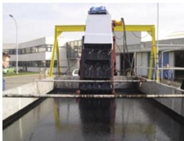
Essais des récupérateurs EGMOLAP (en haut) et LAMOR (à droite) sur le plateau technique
