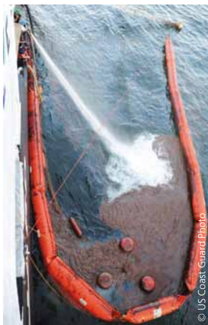
Récupérateur à seuil RoClean Desmi Terminator dans le golfe du Mexique
