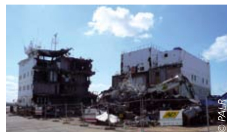
Chantier de découpage du château et de la chaudière après désamiantage
