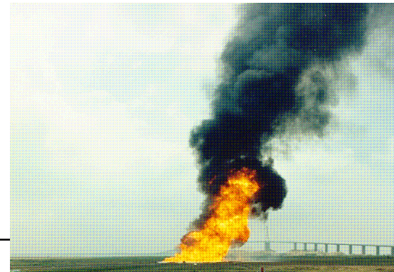
LNG pool fire over water (Gaz de France)
