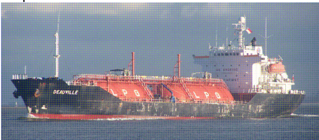
Navire transporteur de gaz équipé de citernes pressurisées
