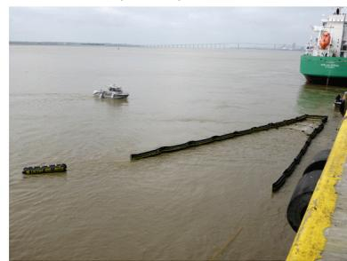
Positionnement du Speed Sweep en configuration statique, en association avec le Ro-Kite (Source : Cedre)
