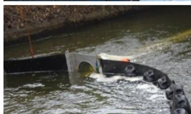
Ci-dessus : *Trash Trap* (haut) et *Trash Tube* (ici couplé à des sections de *GlobeBoom*) (bas) (Source : *DESMI*)
