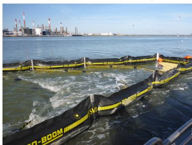
Atténuation du courant de surface par filets en kevlar successifs au sein du DESMI Speed Sweep (Source : Cedre)
