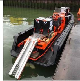
Prototype de l'OSRC (construction Tideman Boats) avec lanceur de barrage jetable HARBO (Source : [www.harbo-technologies.com](http://www.harbo-technologies.com))
