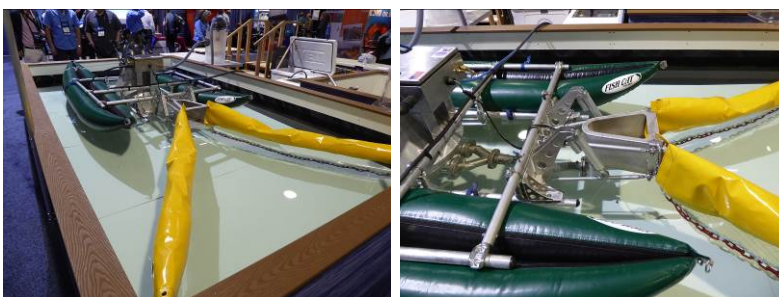
Vues d'un petit modèle exposant le concept de récupérateur PPR Alaska Otter (ici sur catamaran Fish Cat) (Source : Cedre)
