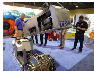
Prototype du dispositif DESMI d'épandage de repousseurs (posé sur le sol) et de mise à feu de nappes (suspendu) (Source : Cedre)
