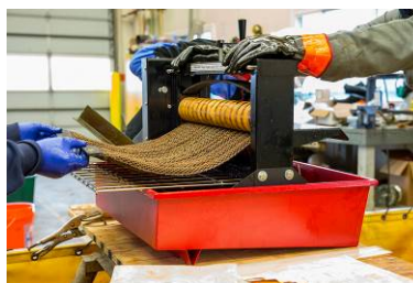
Tests d'extraction par pression des hydrocarbures absorbés (Source : Argonne National Laboratory)
