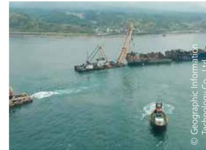
Renflouement, remorquage et chargement de la partie arrière de l'épave sur la barge à pont semi-submersible
