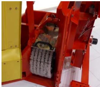
Vue du récupérateur oléophile à brosses rotatives à la base du bras récupérateur (Source : Cedre )
