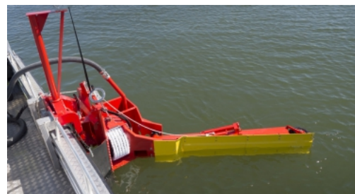
Le bras récupérateur MiniBagger (Source : SeaHow )
