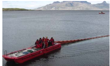
Déploiement de barrages par un Seahunter double coque avec moteur 25 Cv (LSH 25 SC) (Source : Lamor)
