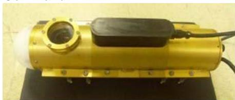
Vue du prototype du capteur *Oscar*, d'hydrocarbures submergés ou coulés (Source : *EIC Laboratories*)
