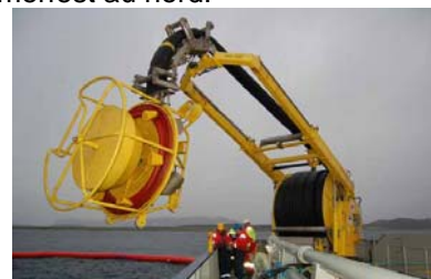
Système TransRec 150 équipé d'une tête de récupération à seuil (Source : Framo)
